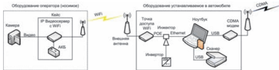
Рис. 2. Базовая конфигурация СПОВИ
