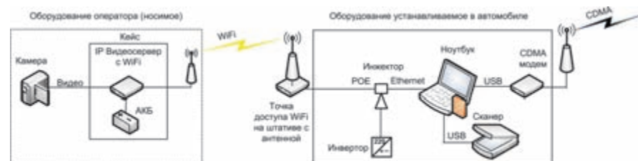
Рис. 3. Конфигурация СПОВИ с выносом точки доступа WiFi
